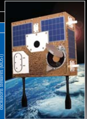
Microsatellite microvariabilité et oscillations stellaires (MOST)
